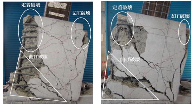
写真1 CRS2510-0-C+の破壊状況( $\theta = 0.24\text{rad}$ )
