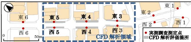
図1 実測調査 測定点・CFD解析領域 評価箇所
