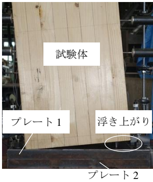
図4 最終破壊状況
