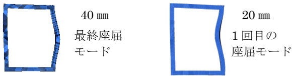
図5 □55×40の左側鋼管の座屈モード(変形倍率5倍)
