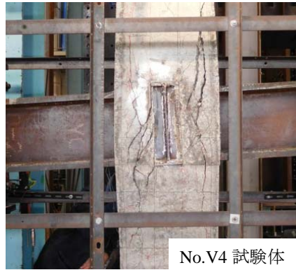
写真-1 ひび割れ状況 (R=40/1000rad)
